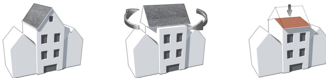
Schéma de principe illustrant la transformation d'un mur pignon en un mur gouttereau 295
