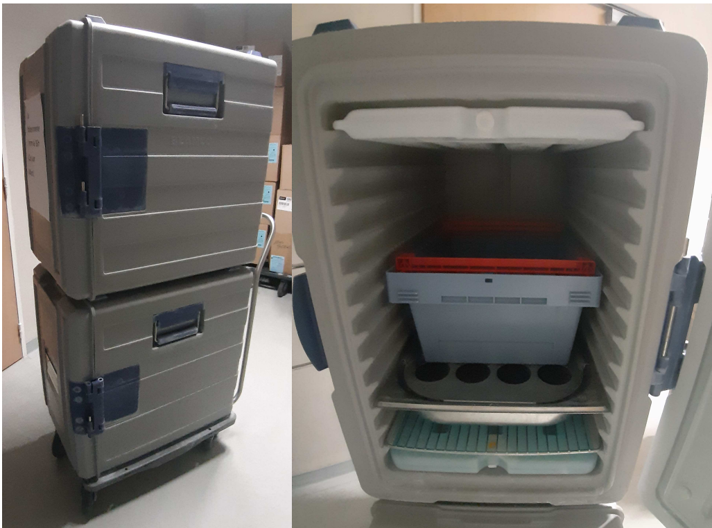
Figure 3 : chariot de transport du lait avec plaques eutectiques
