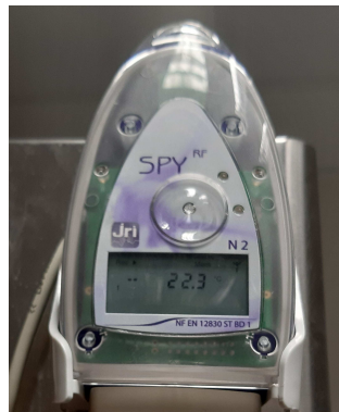
Figure 4 : système de traçabilité informatisé de la température SPY®
