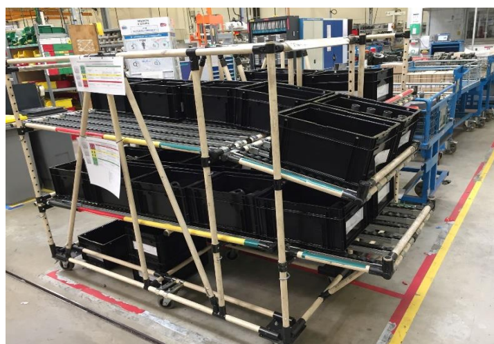
Figure 37 : Système de kanban mis en place dans le secteur P1N pour la gestion du stock de manchons et couvercles
