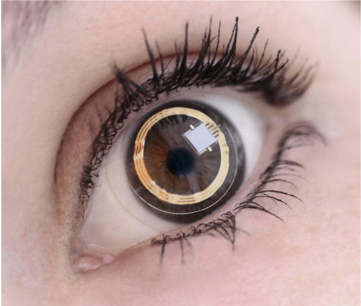
Figure 2 : Photographie de la lentille de contact du dispositif Sensimed Triggerfish® une fois mise en place sur la cornée. Sensimed.
