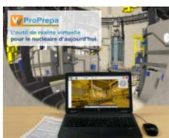
VVProPrépa, « décrit comme le Google Street View de la centrale », est un logiciel conçu par la R&D d'EDF. Grâce à la réalisation de milliers de prises de vues numérisées, cet outil permet aux utilisateurs de se déplacer virtuellement dans le bâtiment réacteur, d'inspecter les étiquettes de matériels, de mesurer des distances et calculer des itinéraires.
