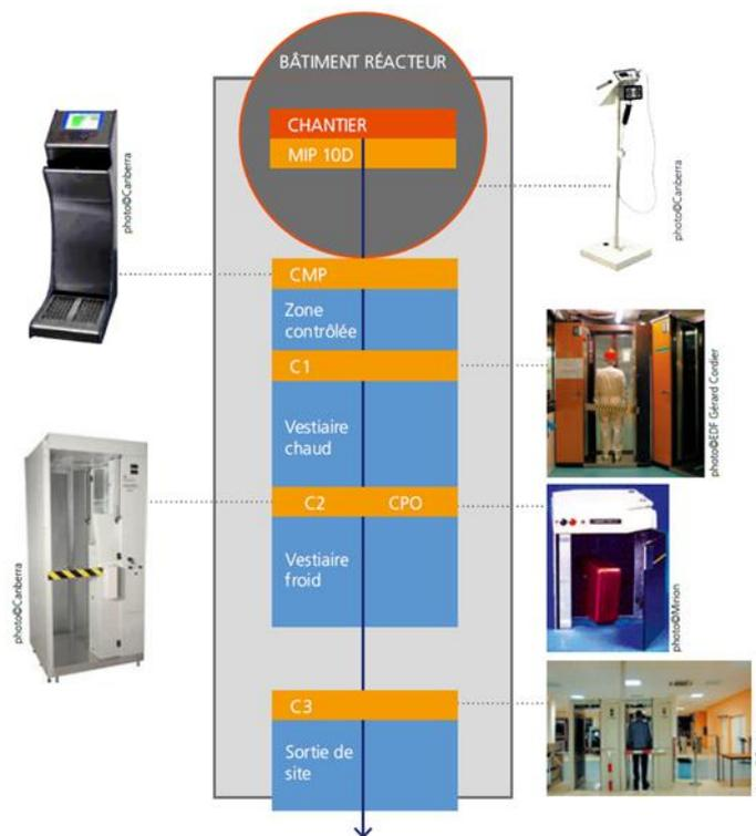
Figure 14 - Appareils de détection de la contamination
