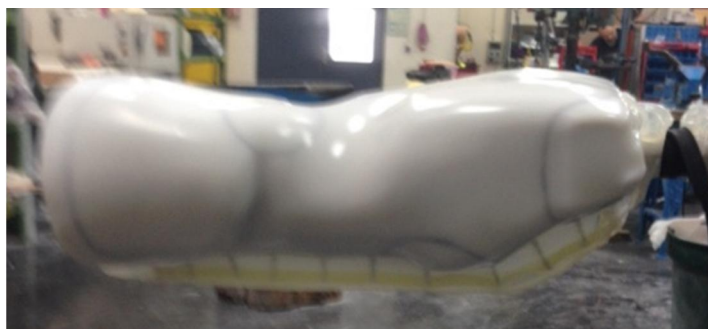
Photo 6 : Polyuréthane une fois le vide fait
