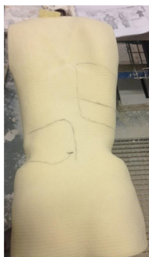
photo 4 : Marquage des points d'appuis avant ponçage
