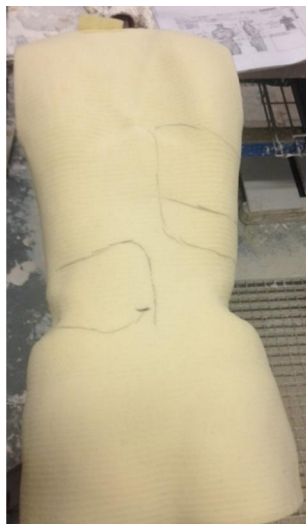
photo 4 : Marquage des points d'appuis avant ponçage
