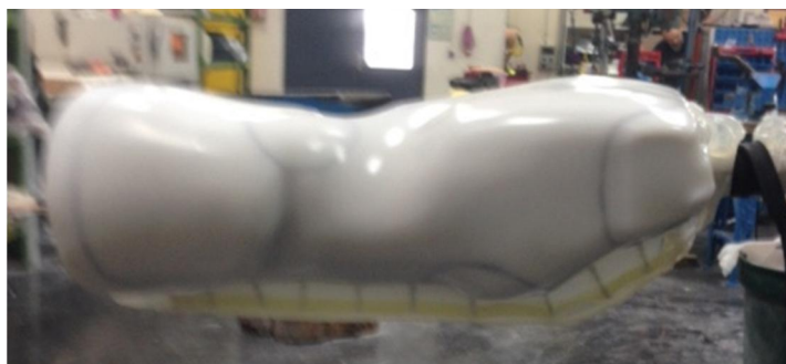
Photo 6 : Polyuréthane une fois le vide fait
