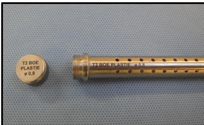
Figure 74 : Marquage laser sur tube en inox
