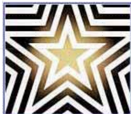
Test de Bowie-Dick non conforme
