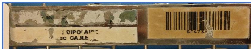
Figure 32 : Plateau d'instruments avec étiquette en ruban laminé détérioré, exemple avec perte du libellé du plateau opératoire et du service de la composition
