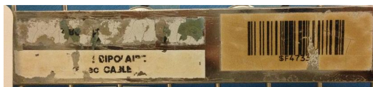
Figure 23 : Dégradation importante des étiquettes en ruban laminé
