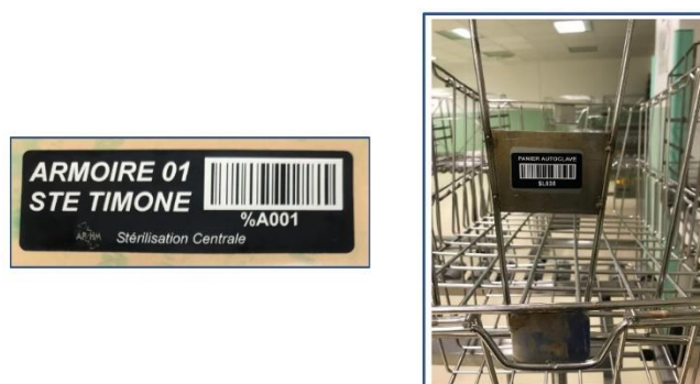
Figure 83 : Etiquettes en aluminium pour les armoires et les paniers d'autoclave
