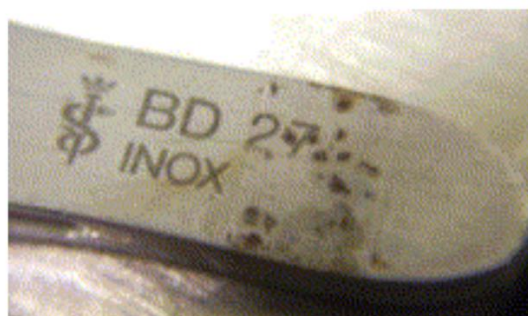
Figure 55 : Corrosion par piqûre(47)
