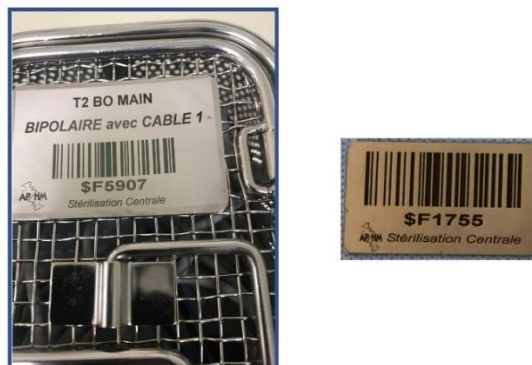
Figure 57 : Paniers et étiquettes en acier inoxydable avec marquage laser
