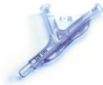
Figure 46 : Exemple de canule en plastique gravée (laser trotec)
