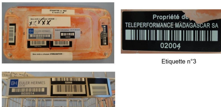
Figure 26 : Etiquettes « test ». L'étiquette n°3 sur support en aluminium n'est plus lisible.
