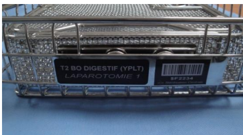
Figure 59 : Etiquettes en aluminium anodisés avec marquage laser
