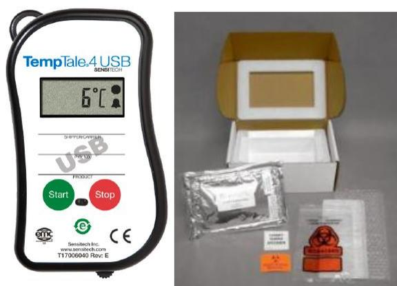
**Figure 25 : Dispositif d'alarme de température TempTale (à gauche), nano cool box et son contenu (à droite)**
