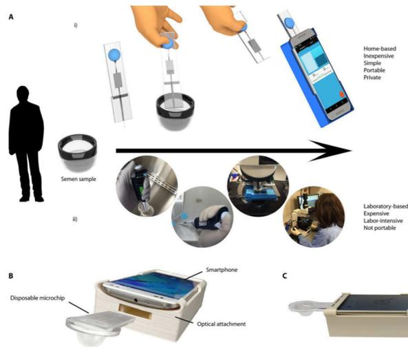
**Figure 45** - Procédure d'utilisation de l'analyse de sperme utilisant le dispositif lié au smartphone (Kanakasabapathy et al. 2017)
