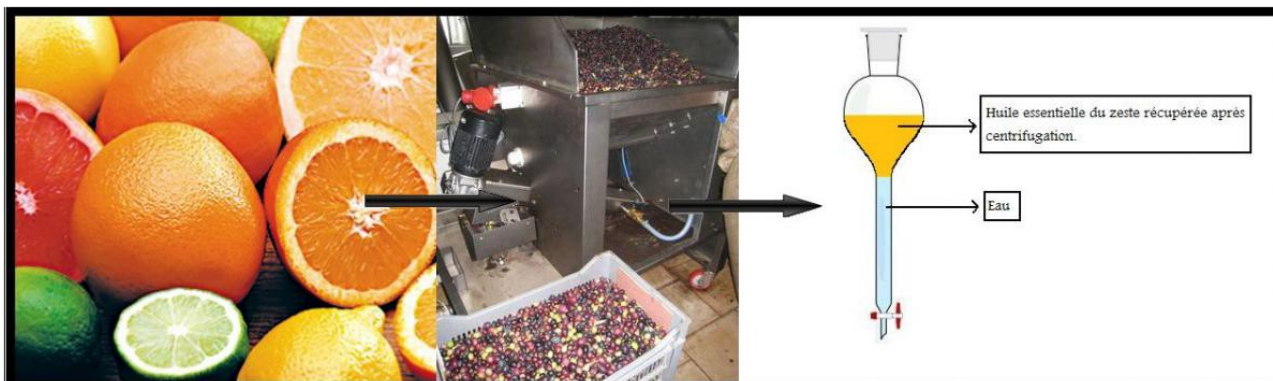
Illustration 2 : schéma de l'expression à froid (13)
