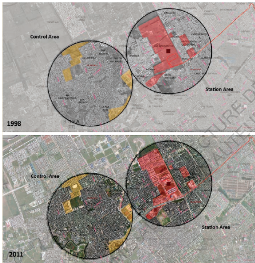
Figure 25 : Développement urbain à proximité du terminus d'une ligne du TransMilenio (Suzuki et al., 2013)
