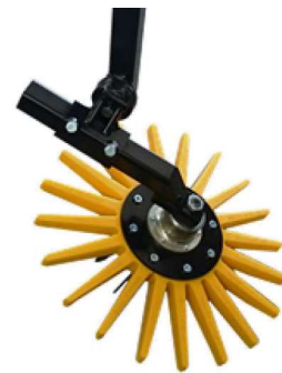
Figure 7 : Doigts Kress (K.U.L.T.)
