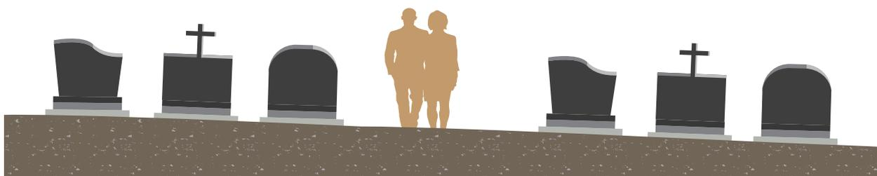
Figure 18 : Coupe de principe de l'implantation des tombes perpendiculairement à la pente du terrain (CHIRON, 2019)
