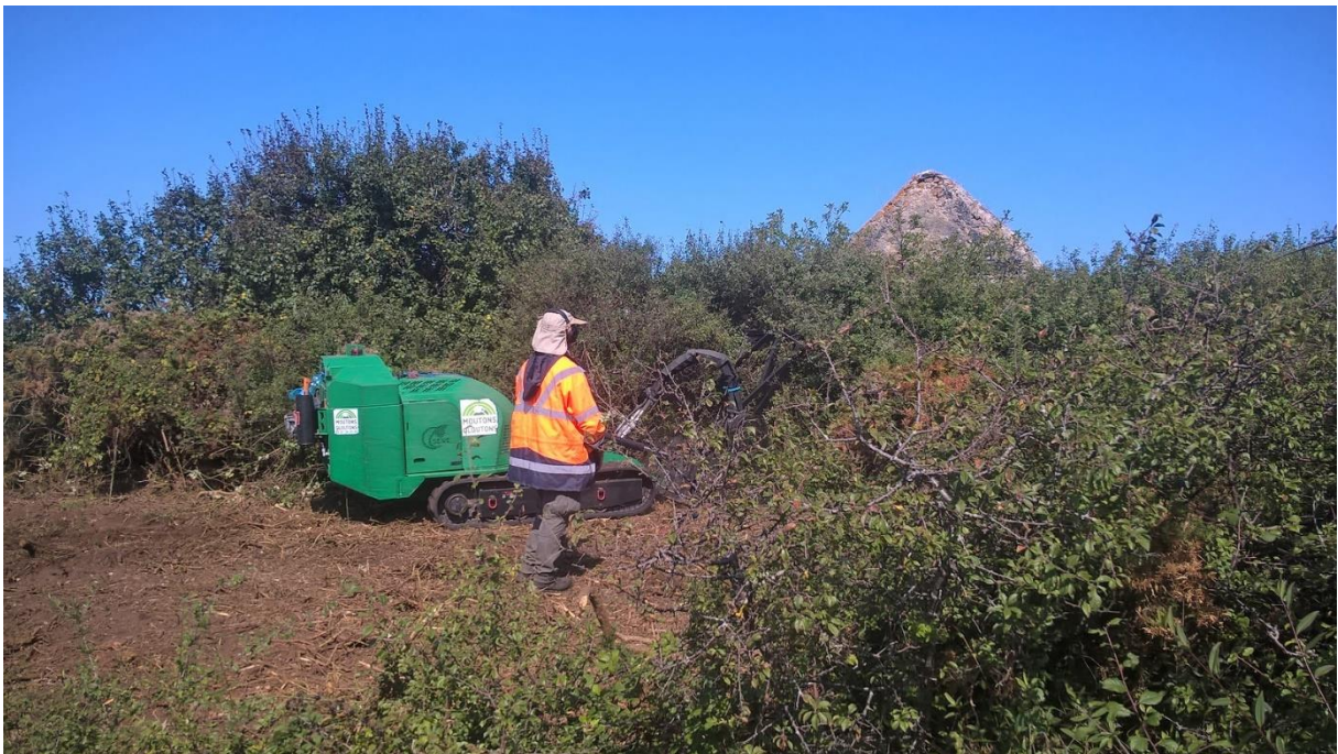
Figure 30 : Robot radiocommandé utilisé pour ouvrir des layons dans les fourrés au préalable de la dératissage de l'île, ici en train de rendre accessible un amer (Bonneau B. 2019)
