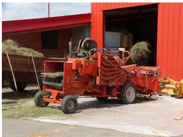
Figure 8: Battage de la lavande à la batteuse (M-C. Baills, 13/08/2019, Chemillé)
