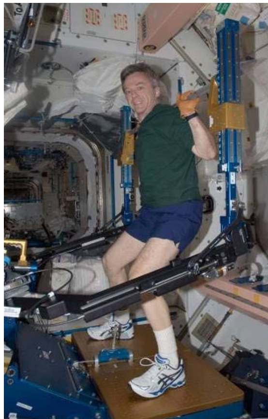
Figure 25 : Astronaute Canadien Robert Thirsk s'entraînant sur la machine de musculation ARED à bord de l'ISS (nasa.gov)
