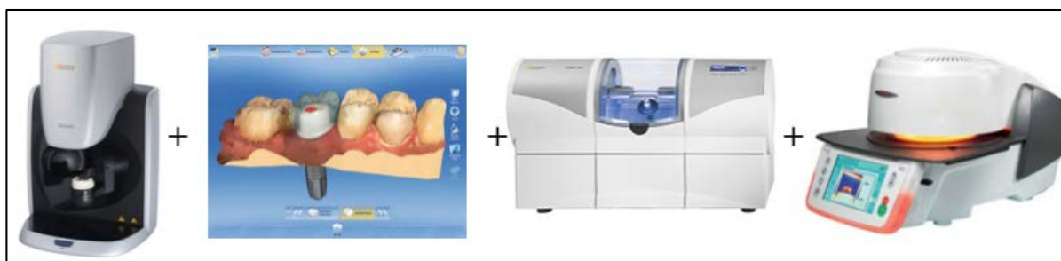
Fig 72 : Vue d'ensemble des différentes machines nécessaires à l'investissement du prothésiste : un scanner de table, un poste de CAO, une usineuse et un four
