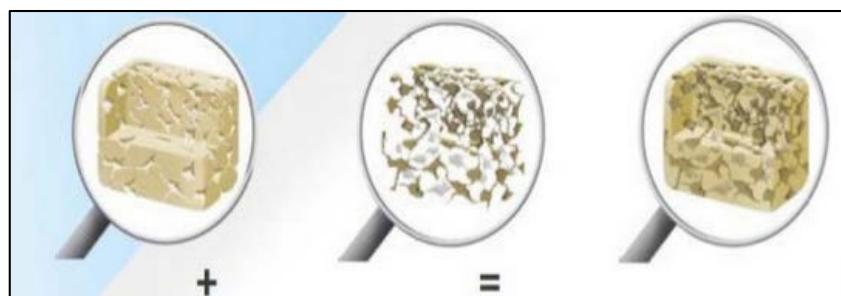
Fig 51: Composition céramique hybride: trame poreuse de céramique et composite (Canivet 2014)
