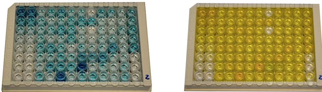
Figure 16: Test ELISA, après incubation du substrat de révélation (TMB) et mise en place de la solution stop.
