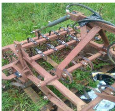
Le **vibroplanche** permet aux producteurs de préparer un lit de semence ou plantation convenable avec une vitesse de travail à 2 ou 3 km/h. Les dents de vibroculteur à doigts droits vont ameublir le sol dans les premiers centimètres et les dents de herse situées juste derrière vont niveler le sol et pulvériser les mottes. Différents types de rouleaux sont adaptables en fonction de son type de sol pour finir le travail d'affinement et avoir une surface homogène.
