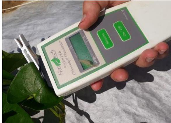
Figure 24 : Fluorimètre (Pocket Pea) en position de mesure. La feuille est pincée par le clip contre lequel est appliqué directement l'appareil de mesure. Source : A. Peter
