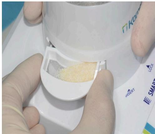
**Figure 12 :** Particules dentinaires de 300 à 1200  $\mu\text{m}$  au niveau de la première chambre inférieure.
