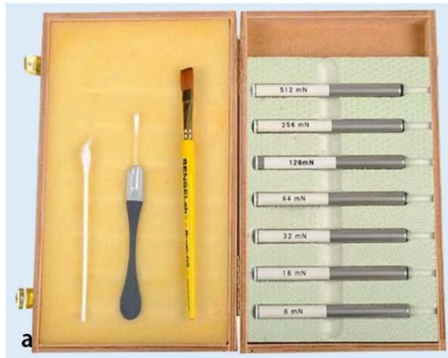
Fig 3.11. Dispositifs d'évaluation mécanique des fonctions stimuli/réponse, de la sensibilité mécanique et de l'allodynie dynamique (Mucke et al. 2015).
