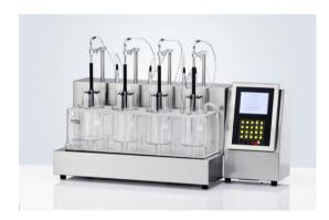
Figure 15 : Appareil pour test de désagrégation de marque PharmaTest (29)
