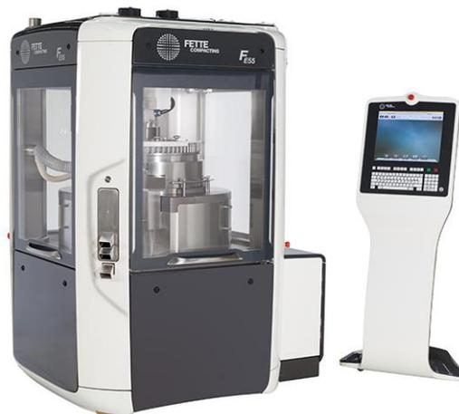
Figure 6 : Presse à comprimer rotative de la marque FETTE<sup>(17)</sup>
