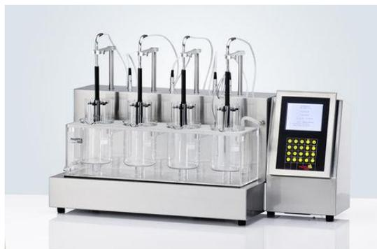
Figure 15 : Appareil pour test de désagrégation de marque PharmaTest<sup>(29)</sup>
