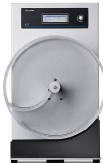
Figure 14 : Friabilimètre de la marque Sotax<sup>(28)</sup>
