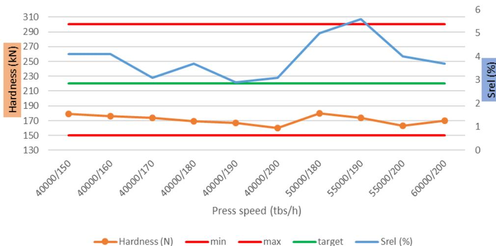
Figure 34 : Impact du couple de vitesses sur la résistance à la rupture – Lot Y04941V
