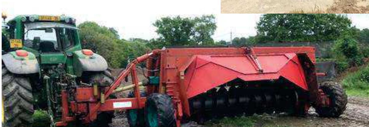
Figure 7 : retourneur d'andain de la Cuma Aff-et-Vilaine, utilisé à deux reprises pour le retournement. Pilotée par le chauffeur de la CUMA
