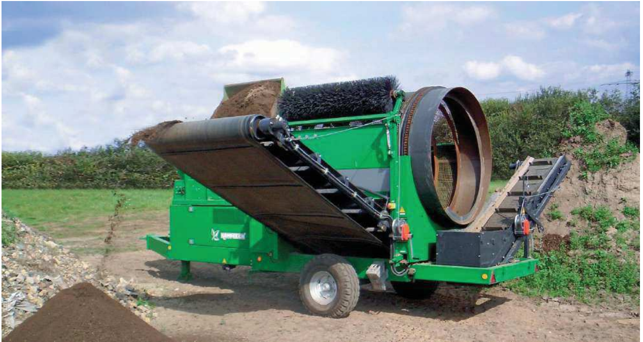
Figure 21 : exemple de cribleuse à compost végétal. Example of grain sifter for vegetal compost. ( http://www.hantsch.fr/wp-content/uploads/2012/05/Joker_300dpi_1.jpg )
