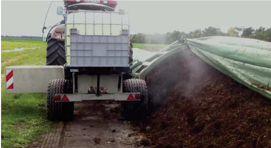
Figure 24 : Le retourneur d'andain Gujer TG-301 équipé d'un guide-bâche et d'une rampe d'arrosage en fonction serait bien adapté aux besoins du groupe Rocher. The compost reverser Gujer TG-301 equipped with a tarp leader and an irrigation device corresponds to the needs.
