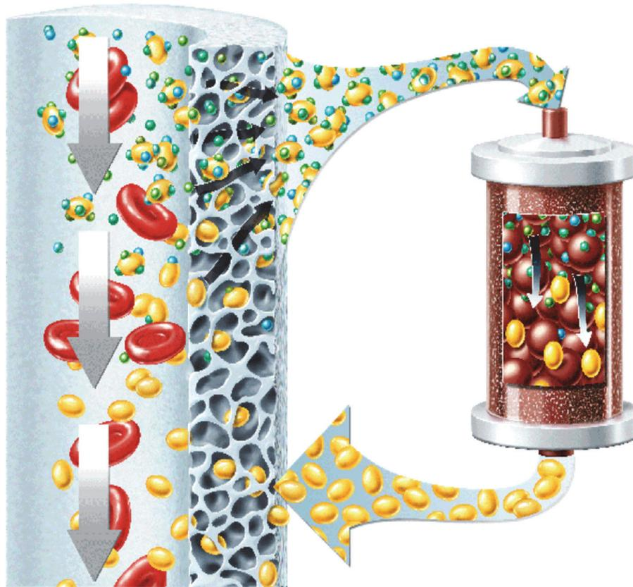
**Figure 8 : Membrane Albuflow, membrane sélective, cut-off 250 kDa permettant une sélection par diffusion de l'albumine ainsi que les molécules de plus petit poids moléculaire.**
