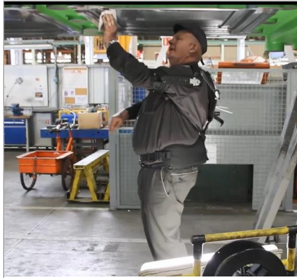
Photo 4: Opérateur avec exosquelette M. Sup. - Nettoyage des matrices de presse.
