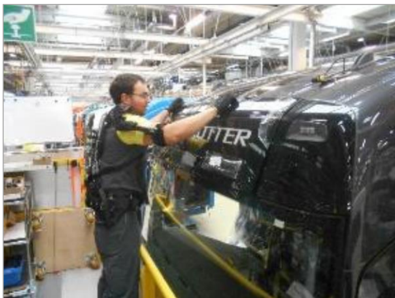
Photo 7: Opérateur au poste de montage de pare-soleil et barre de toit
