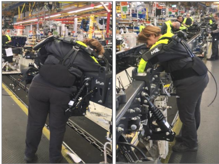
Photo 9: Opératrice revêtue d'un exosquelette au poste de cheminement des faisceaux
