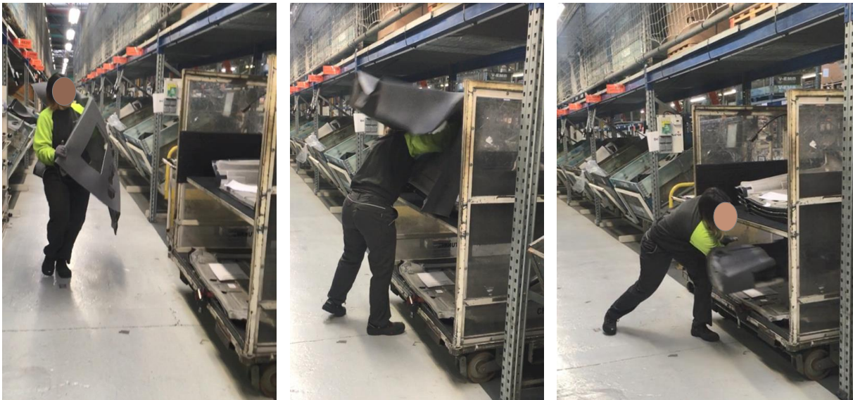
Photo 18: Dépose de tapis tunnel en base roulante (à g.: stratégie de port des tapis tunnel; au centre: dépose en partie haute; à dr.:dépose en partie basse)
