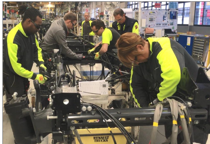
Photo 8 : Opérateurs (à droite) au poste de cheminement des faisceaux.
