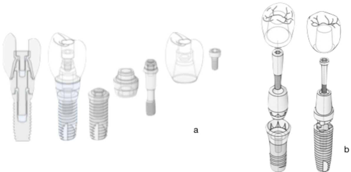
Figure 10 a : système transvissé (empilé), b : système scellé [8]
