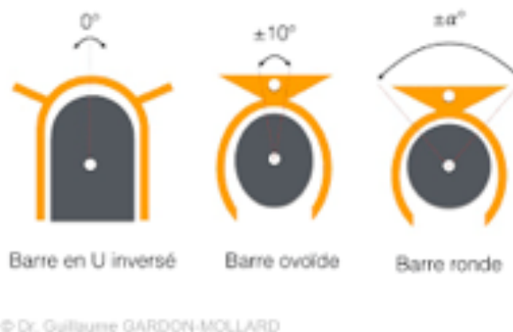
Figure 47: schéma représentatif du type de liaison, articulée ou rigide, en fonction du type de barre.
