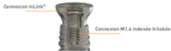
Figure 20 : Implant Tissue Level Axiom (Anthogyr ® ) avec sa double connexion : connexion In Link ® pour les restaurations plurales transvissées et connexion indexée trilobée pour les restaurations unitaires
