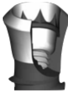
Figure 18 : Vue en coupe d'une connexion basée sur le principe du cône morse avec indexation (implant Straumann®) [17]
