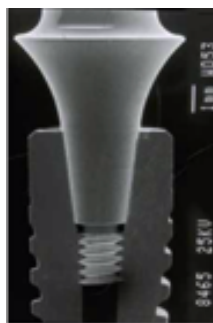
Figure 17 : Vue en coupe d'une connexion basée sur le principe du cône morse (implant Ankylos de Friadent®) [17]
