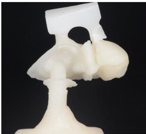
Découpe du cylindre à l'aide d'un disque puis d'une sableuse afin de récupérer notre pièce.
