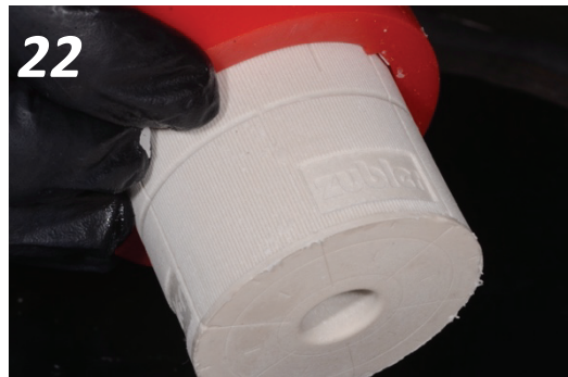
Figure 41 : Désinsertion du bloc contenant la pièce en zircone
