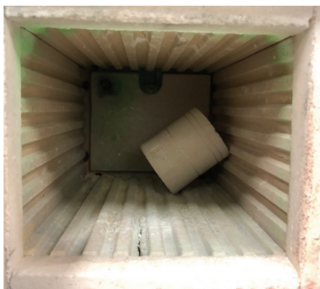
Figure 42 : Pyrolyse de la cire : montée en température à 850°C pendant 45 minutes
