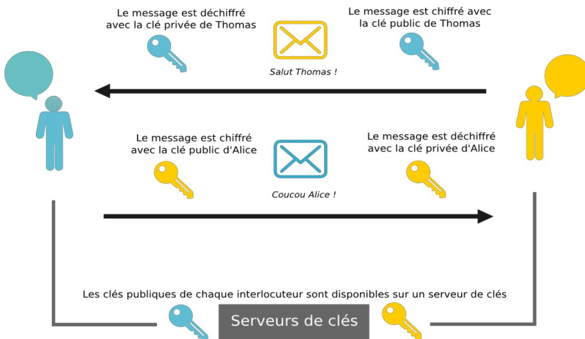
**Figure 5 : Principe de cryptographie**
