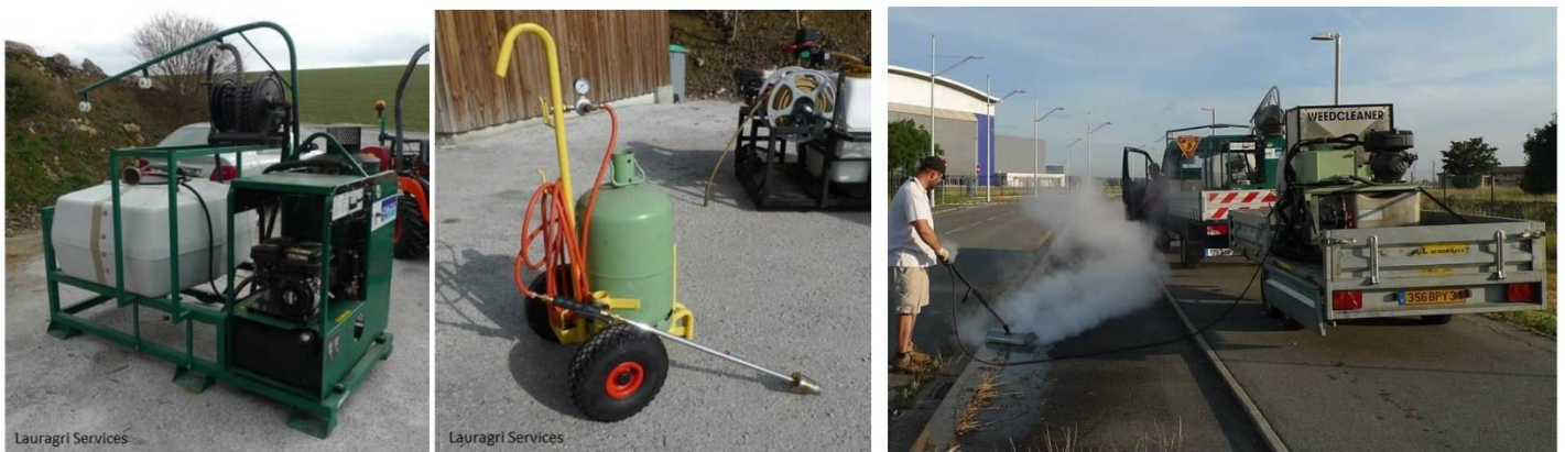
Figure 10 - Matériels utilisés pour le désherbage thermique. A gauche : modalité eau chaude ; au milieu : modalité brûleur à gaz à flamme directe ; à droite : modalité vapeur (Compamed, 2013)
