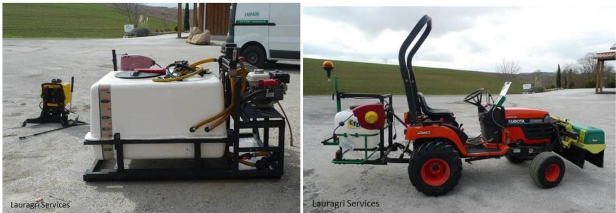
Figure 9 - Matériels utilisés pour le désherbage chimique. A gauche, la pompe à dos pour la pulvérisation manuelle (présent sur la photo également la cuve pour la référence tracté) ; à droite : le pulvérisateur à détection optoélectronique (Compamed, 2013)
