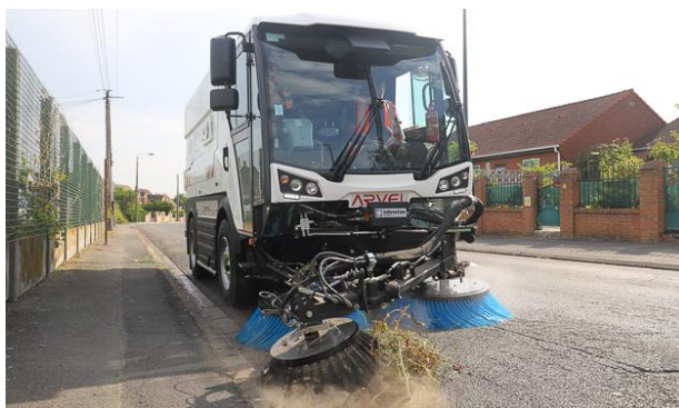
Figure 7 – Balayeuse permettant de désherber les voiries (Ville Avion, 2019)
