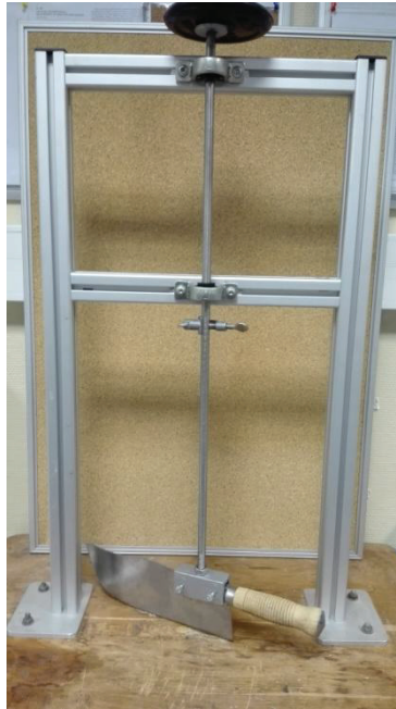
Fig. 8 - Dispositif utilisé pour produire des lésions osseuses. La feuille de boucher est fixée à un piston central. Ce dispositif permet le calibrage de l'énergie cinétique selon la hauteur de chute.
