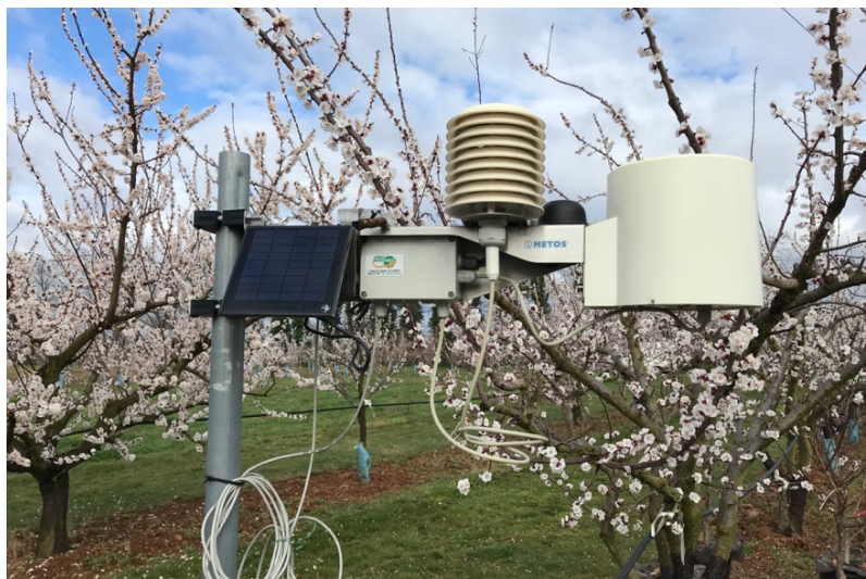
Figure 19 : Station météo iMETOS et ses capteurs de température, de pluviométrie et d'humectation foliaire.
