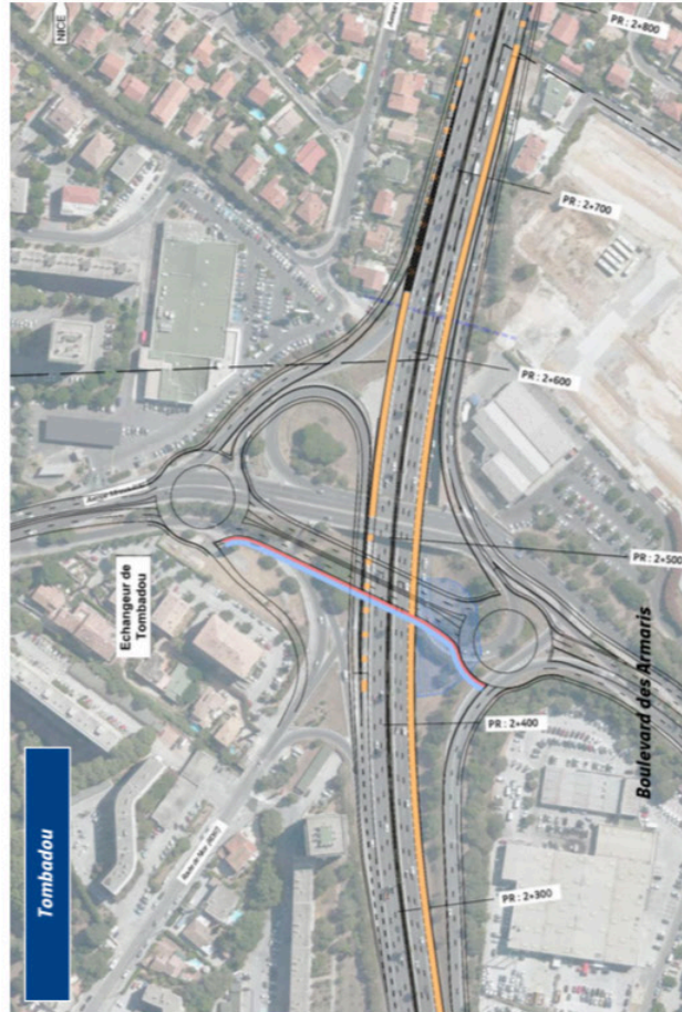
Figure 24 : Aménagement de l'échangeur de Tombadou
