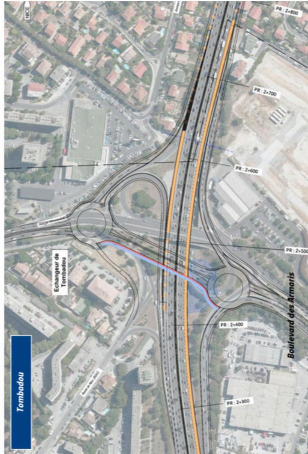
Figure 24 : Aménagement de l'échangeur de Tombadou
