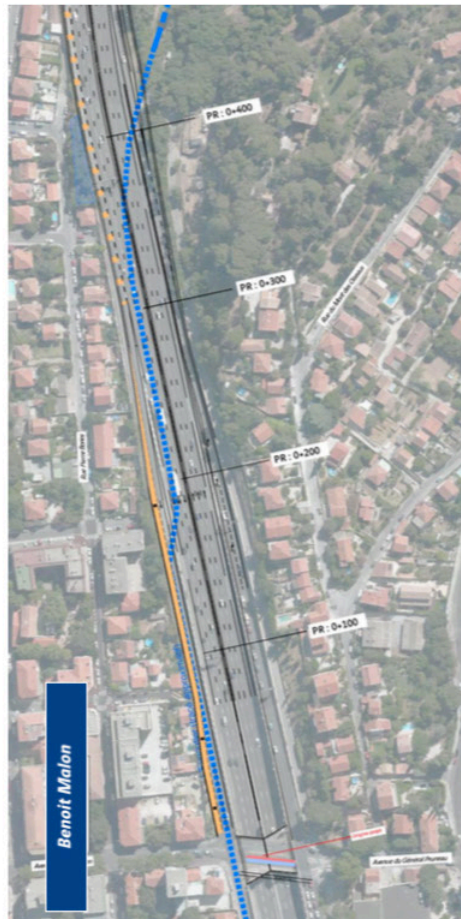
Figure 22 : Aménagement du demi-diffuseur de Benoit Malon
