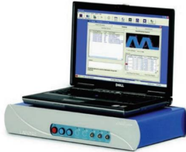
Figure 237 Générateur pour stimulation électrique
