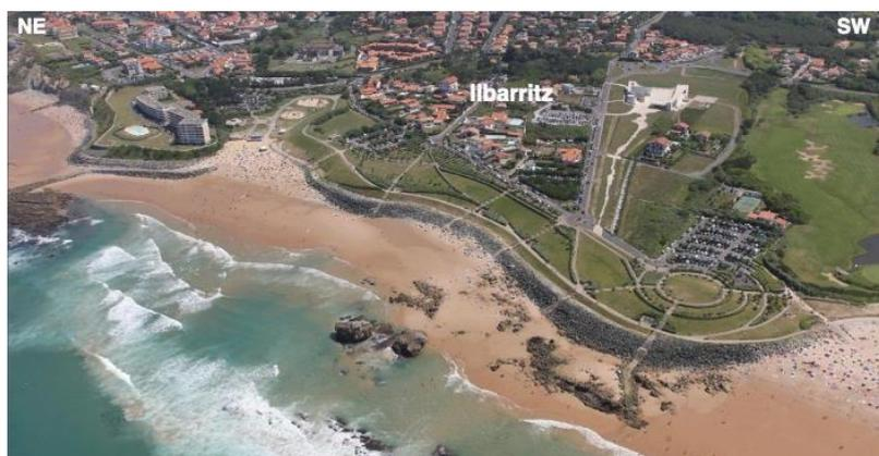
Biarritz, 2013 (Observatoire de la Côte Aquitaine), ce sont des plages de poches artificielles d'environ 400 m. Elles présentent une rupture de pente de 4% en bas d'estran sur la plage émergée contre environ 1% sur plage immergée.
