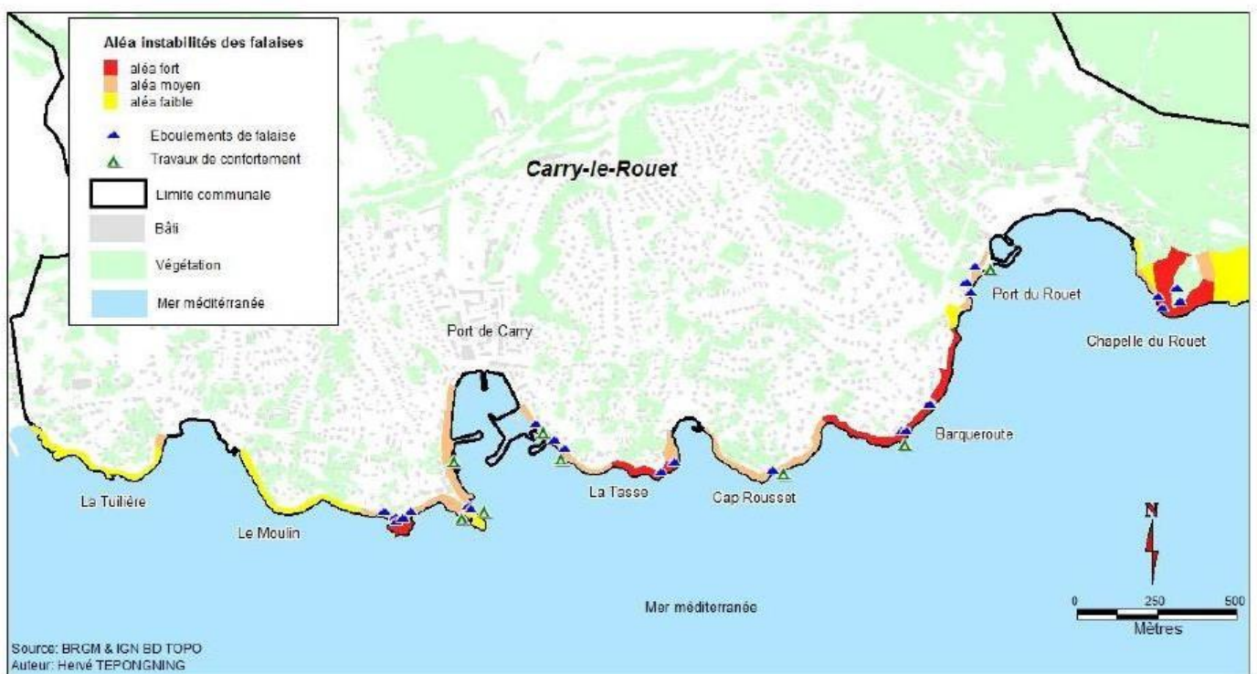
Carte 2: Aléa instabilité des falaises littorales, éboulements et travaux de confortement de la commune de Carry-le-Rouet, 2015 (TEPONGING Hervé, BRGM projet VALSE 2012-2015)
