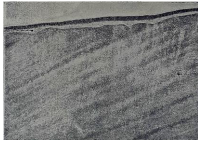
Figure 33 : Coupe longitudinale d'une dent laquée observée au microscope ultra-opaque
