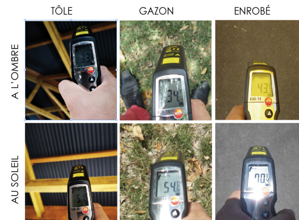
Fig 26 : Relevés des températures à l'ombre et au soleil sur différents matériaux au voisinage du bâtiments Source : CAUE974, 2019
