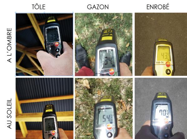
Fig 26 : Relevés des températures à l'ombre et au soleil sur différents matériaux au voisinage du bâtiments
