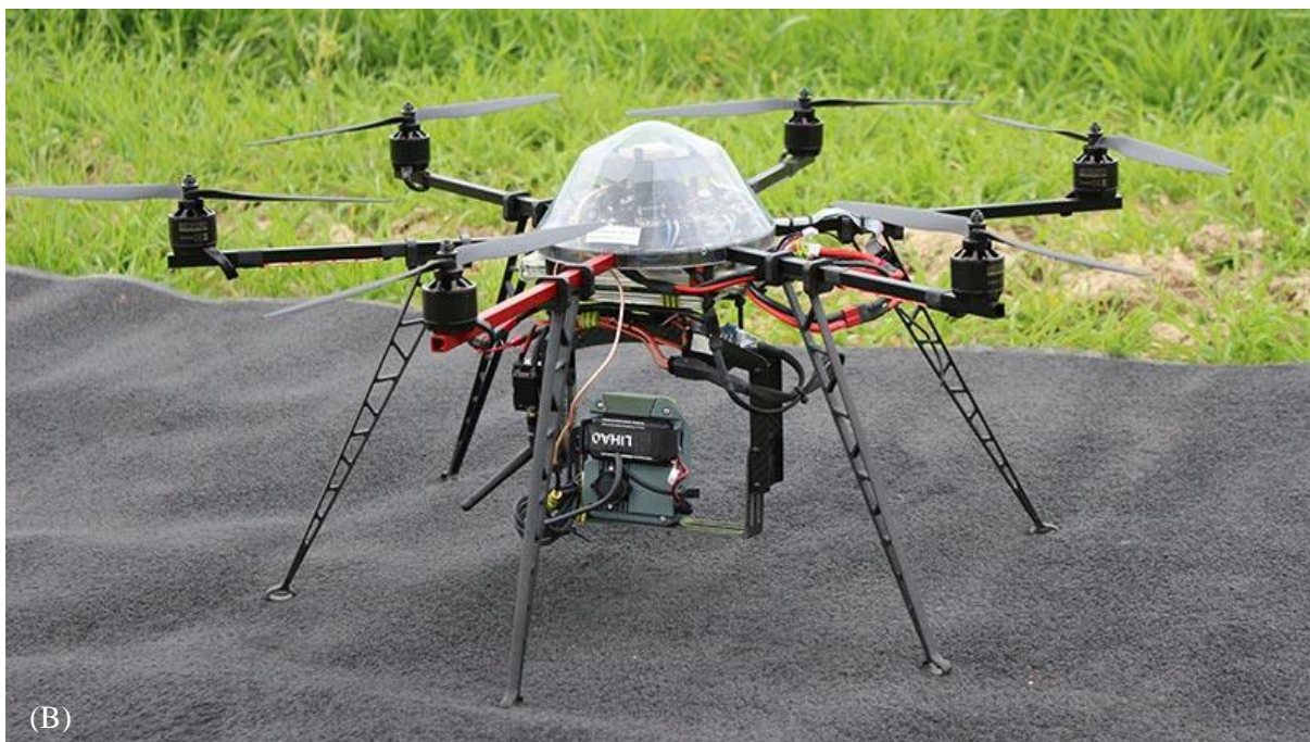
Figure 35 – Dispositifs de phénotypage moins contraignants que la plateforme PhénoField® et potentiellement utilisables chez les sélectionneurs : (A) Phénomobile (haut-débit) et (B) drone (moyen-débit) – d’après Arvalis [7][8]
