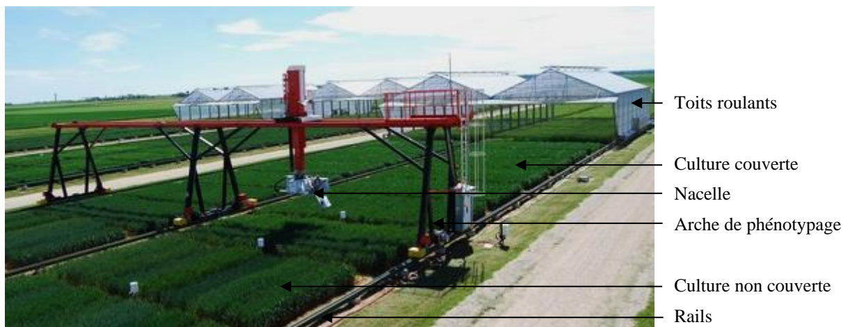
Figure 9 – Arche de la plateforme de phénotypage haut-débit PhénoField® (Ouzouer-le-marché, 41) en cours de fonctionnement – modifié d’après INRA, réseau Phénome [4]. L’arche de phénotypage se déplace sur les rails avec la nacelle où sont situés tous les capteurs afin d’effectuer les mesures. Les toits roulants permettent de couvrir les microparcelles en arrière-plan en cas de pluie pour simuler des stress hydriques.
