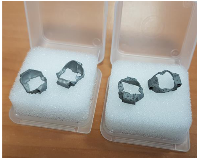
Figure 33: A gauche, des bagues directement après impression en technique MBJ, et à droite en technique SLS (Laboratoire ORTHOMOOV, Eguelles, France)
