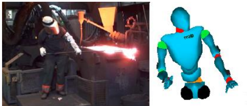
Figure 22 : Illustration de l'opérateur lors d'un écramage à gauche et l'avatar à droite
