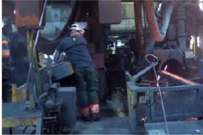
*Photo 7 : Canaliste utilisant le pupitre de commande*
