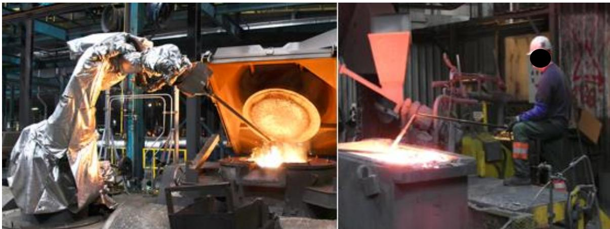
*Photo 10 : A gauche, bras automatisé Inductotherm ARMS® / A droite, canaliste en train de relevé la température*
