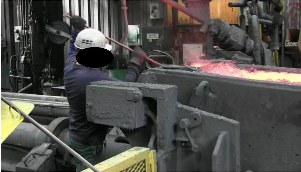
Photo 3 : Opérateur en train de décaler la théière
