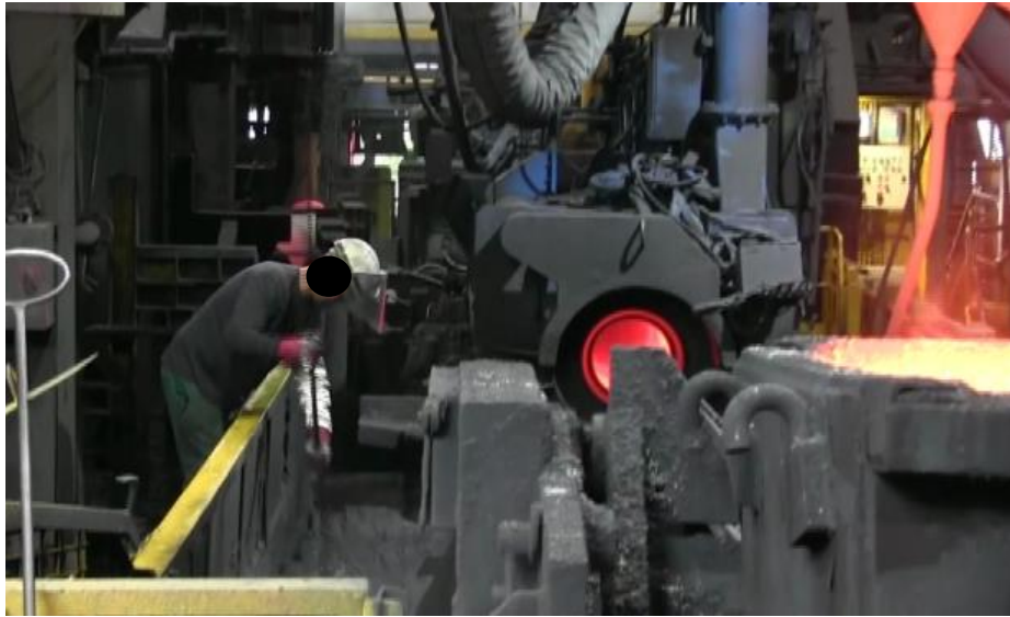
Photo 4 : Canaliste en train de casser les baguettes dans la fosse
