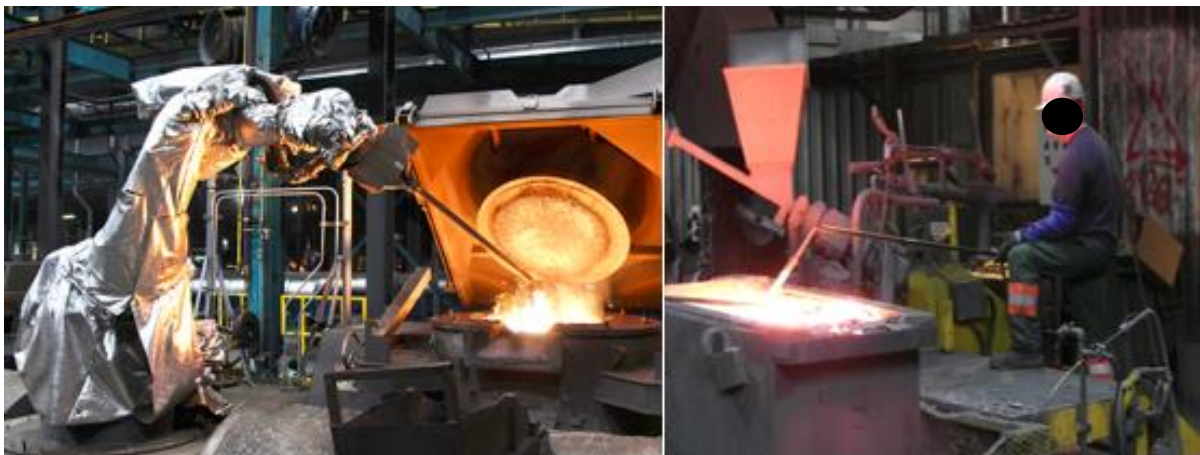
Photo 10 : A gauche, bras automatisé Inductotherm ARMS® / A droite, canaliste en train de relevé la température
