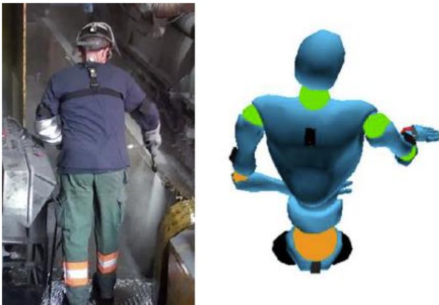
Figure 21 : Illustration du placement des centrales inertielles (Réal VS Avatar)
