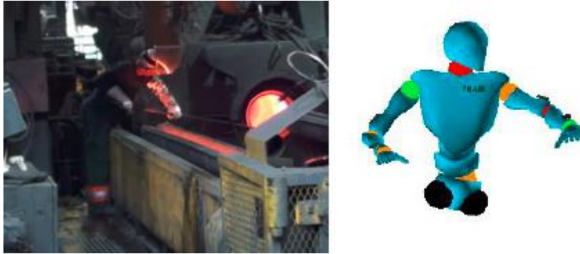
Figure 23 : Illustration de l'opérateur lors du graissage du coupe fonte à gauche et l'avatar à droite
