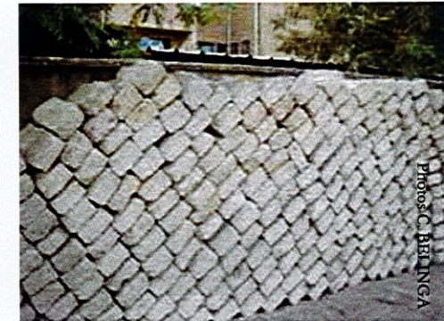
Adobes de seconde mains issues de la démolition d'habitat populaire dans la zone ZACA (Ouagadougou) 2004
