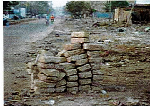
Adobes de seconde mains issues de la démolition d'habitat populaire dans la zone ZACA (Ouagadougou) 2004
